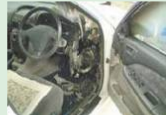
ไฟไหม้เนื่องจากปฏิกิริยาเคมีไฟฟ้าจากน้ำทะเล
