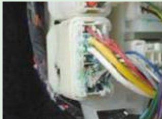
สถานะของทองแดงที่สึกกร่อน โดยการกักร่อนแบบกัลวานิก
